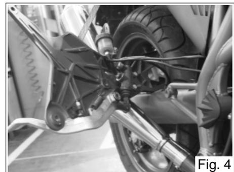
Die alte Mutter wird gegen eine neue selbstsichernde Mutter (61N115193), wie in Fig. 5 bezeichnet, ausgetauscht. Die Anschlagsschraube 5 des Fußbremshebels muß auf das angegebene Maß eingestellt werden. Die Mutter ist mit einem Drehmoment von 10 Nm anzuziehen.
